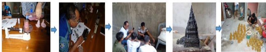
Gambar 6. Proses pembuatan mozaik dari serbuk gergajian batu alam
