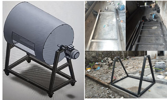
Gambar 6. Desain alat produksi biochar dan proses manufakturnya
