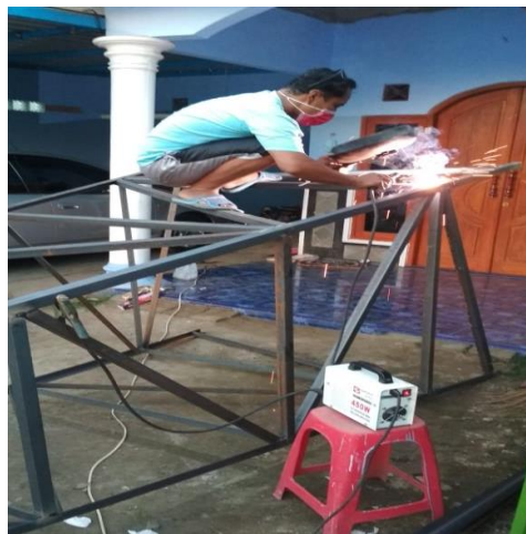
Gambar 6. Pegelasan pada rangka utama alat pengolahan air bersih
