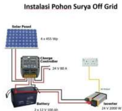
Gambar 3. Desain instalasi pohon surya.
