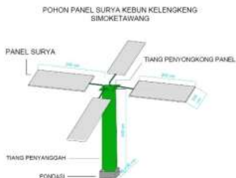
Gambar 2. Desain rangka dan cabang pohon surya.
