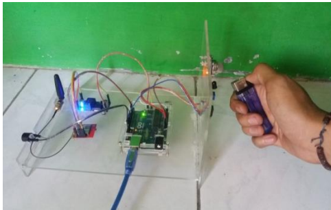
Gambar 4.7. Uji Sensor MQ2 Menggunakan Gas.
