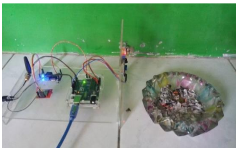
Gambar 4.8. Uji Sensor MQ2 Menggunakan Asap.
