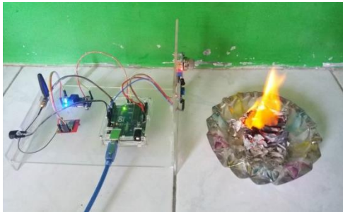
Gambar 4.4. Uji Sensor Api.
