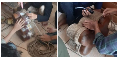
Gambar 8: Pemasangan tali rami mengelilingi kaleng
